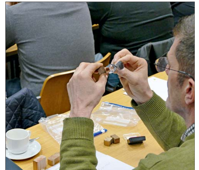
Die Lupe ist eins der wichtigsten Werkzeuge, wenn es um die makroskopische Holzartenbestimmung geht. Die morgendlichen Übungen beim „Klötzchenkurs“, in diesem Jahr mit 40 Teilnehmern, ist fester Bestandteil der Veranstaltung.
